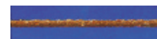
Campione di filo a zincatura arricchita sottoposto a corrosione in nebbia salina per 600 ore
